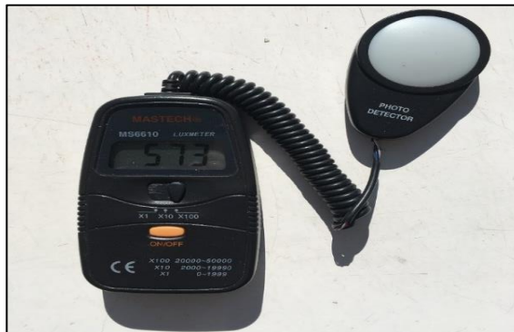
3 pav. Apšvietos matavimo prietaisas liuksmetras.
